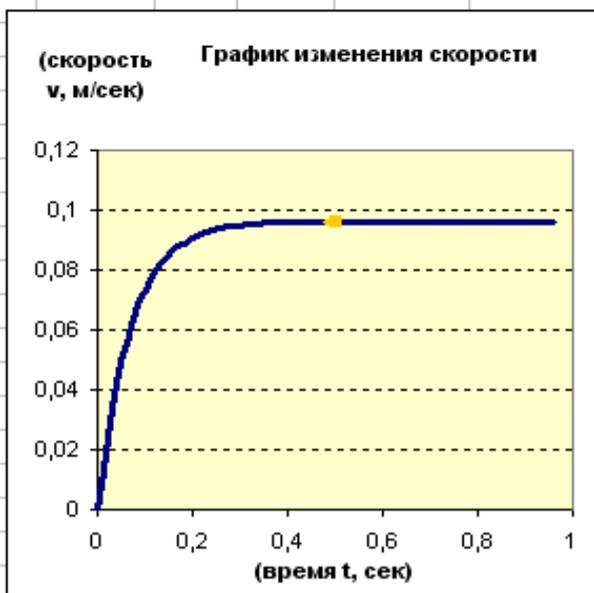
Вывод: примерно через  $t=0,5$  сек. после начала падения скорость становится постоянной и остается такой до конца (график выравнивается, становится параллельным оси изменения времени). При падении в вязкой среде скорость мала, за доли секунды она становится постоянной, поэтому шаг по времени  $\tau$  берется очень маленьким, например 0,02 сек.
